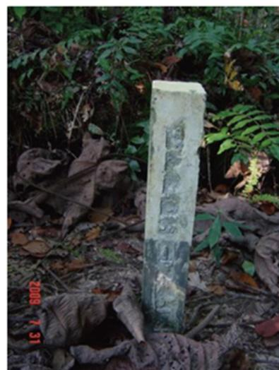
Figure T13-2 Exemple d'un piquet résistant aux perturbations (piquet en béton)
