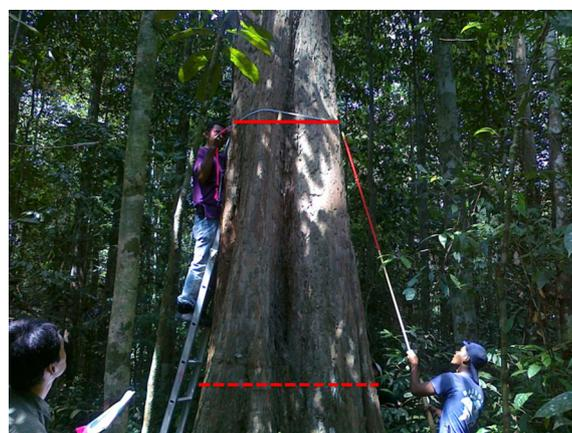
Figure T13-5 Mesure du diamètre d'un arbre dont la racine-contrefort est développée.
