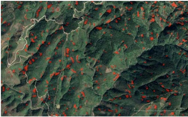
図 T04-1 斜面崩壊地の目視判読
