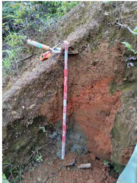
図 4-2-2-22 裸地化した道路下側斜面の土壤断面
