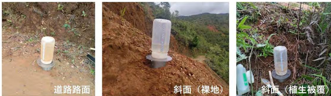
図 4-2-2-21 道路路面や斜面における現場浸透能試験結果
