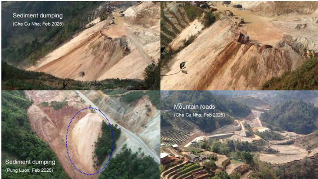
図 4-2-2-14 土砂流出の起源地となっている人工地形改変地
