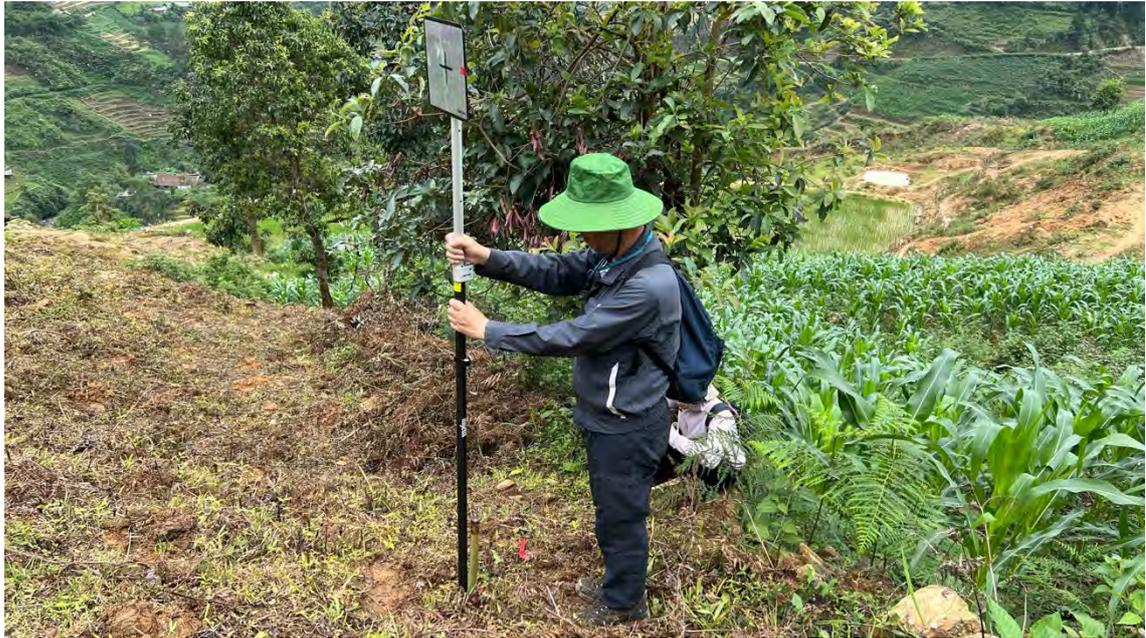
図 4-2-2-2 Che Cu Nha 崩壊地の移動量調査の様子。調査杭の背後にはトウモロコシ畑が広がっている。
