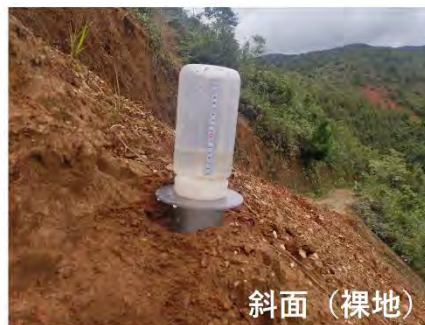
図 4-2-2-21 道路路面や斜面における現場浸透能試験結果
