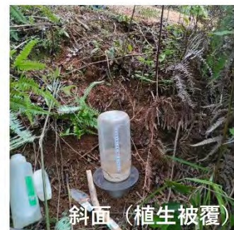
図 4-2-2-21 道路路面や斜面における現場浸透能試験結果
