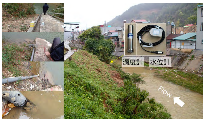
図 4-2-2-9 Mu Cang Chai 水文気象観測所に設置した水位計及び濁度計
