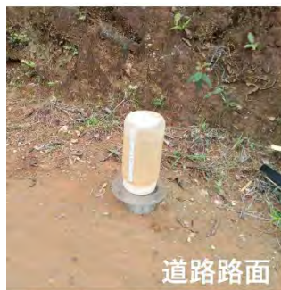
図 4-2-2-21 道路路面や斜面における現場浸透能試験結果
