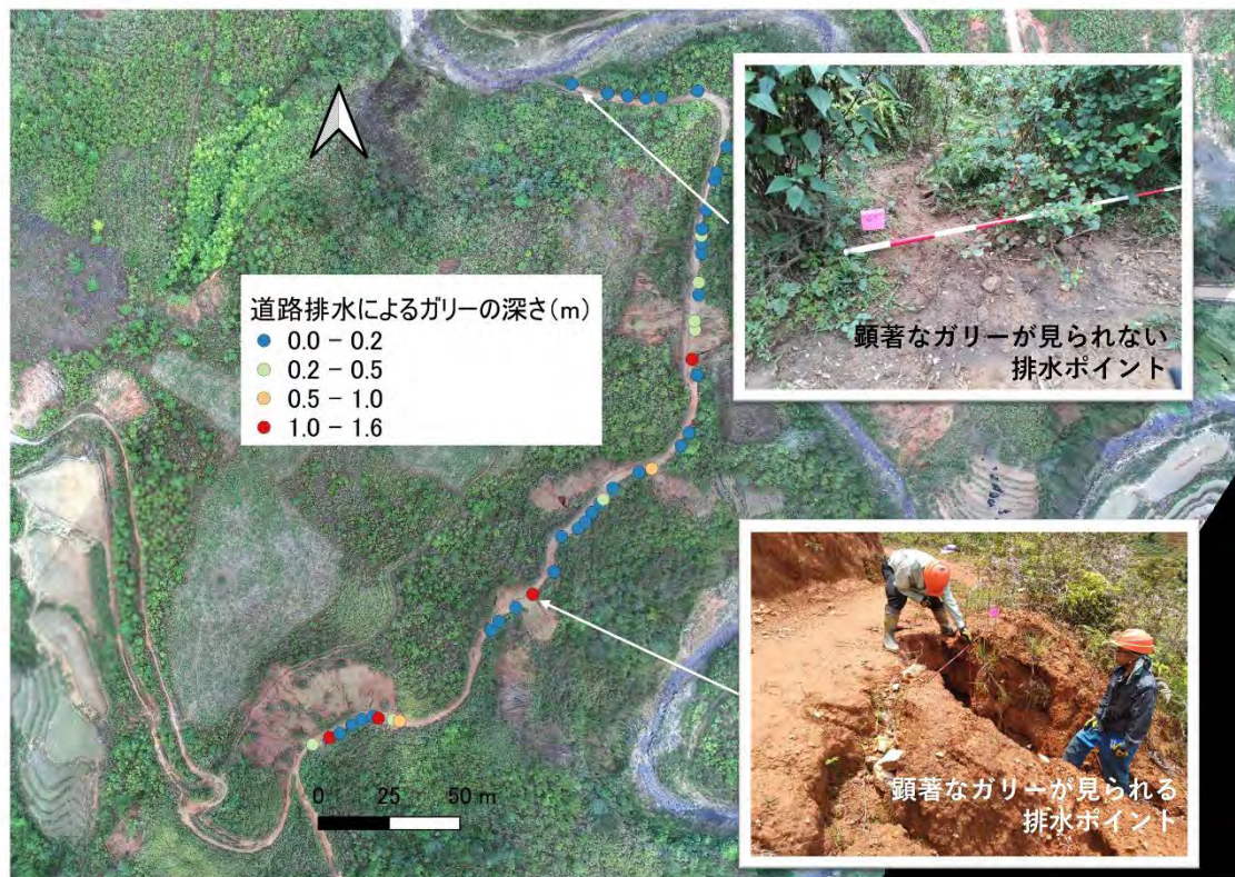
図 4-2-2-20 道路から下側斜面への排水位置と、各排水ポイントで見られた侵食溝の深さ
