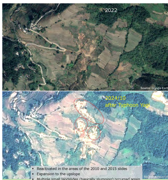
図 4-2-2-3 Che Cu Nha 崩壊地の台風 11 号前後での変化。崩壊地上部での拡大及び内部での再活動が認められる。
