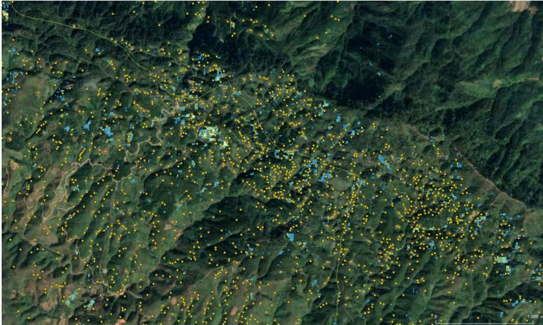
図 4-3-5-7 崩壊地(衛星画像の目視判読)、土地利用/森林攪乱(本事業成果)に基づき作成したリスクマップ。図 4-3-5-3 と比較すると、相対的にリスクが高い範囲が認められない結果となった。実際に発生した崩壊箇所とリスク評価結果が一致しない。
