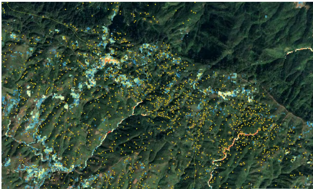
図 4-3-5-8 崩壊地(自動抽出)、土地利用/森林攪乱(本事業成果)に基づき作成したリスクマップ。図 4-3-5-3 と比較すると、道沿いや河川沿いにリスクが相対的に高い結果となった。実際に発生した崩壊箇所とリスク評価結果が一致しない
