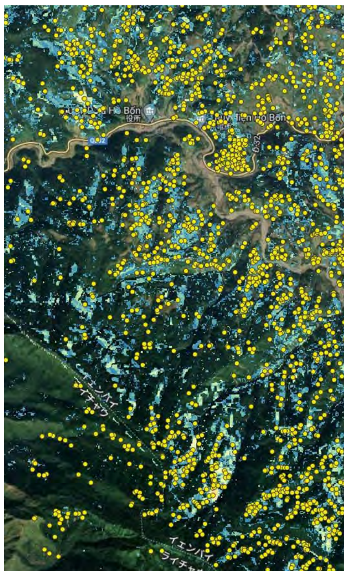
図 4-3-6-1 2023 年 8 月の豪雨により災害が発生した Yen Bai 省 Mu Cang Chai District の HoBon Commune 周辺地域で作成したリスクマップ。本地域において発生した崩壊箇所を災害後に公開された高解像度衛星 (Pleiades Neo、30 cm) より目視判読 (黄色ポイント) し、KimNoiCommune ほかの地域と同じ手法 (土地利用は JAXA のデータ+本事業の森林攪乱分布データを利用) で、崩壊に対してのリスク評価を行い、マップ化した。
