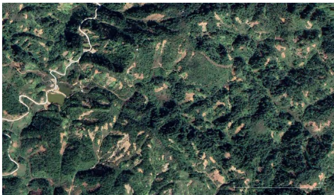
図 4-3-2-2 Mu Chang Chai District(KimNoi Commune ほか)で 2017 年の豪雨にともない発生した崩壊(GoogleMAP の衛星画像より引用)
