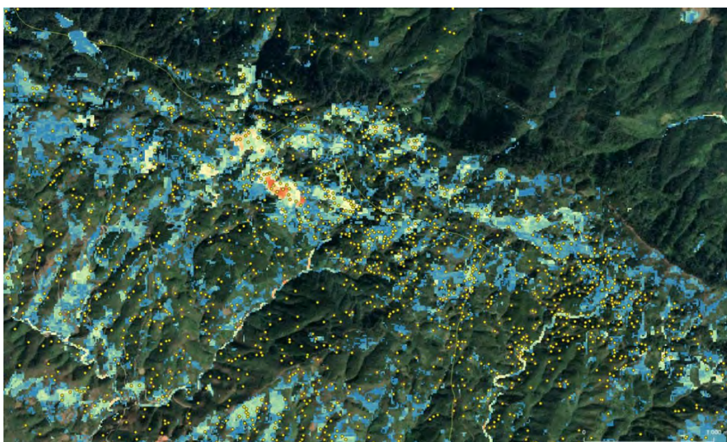
図 4-3-5-5 崩壊地(自動抽出)、土地利用/森林攪乱(JAXA+本事業成果)に基づき作成したリスクマップ。図 4-3-5-3、図 4-3-5-4 と比較すると、相対的にリスクが高い範囲は狭くなる。道路沿いや河川沿いでリスクが高くなる傾向が認められた。
