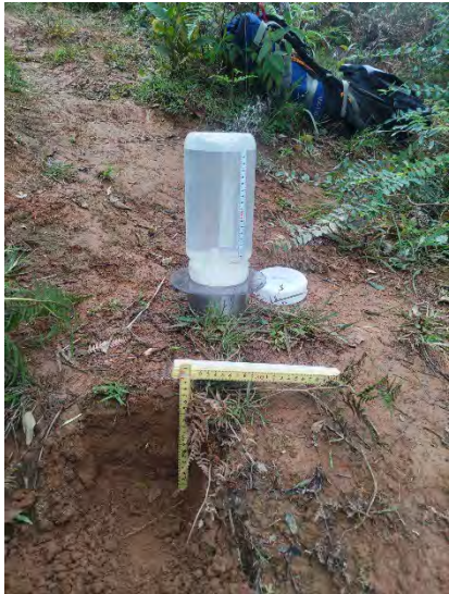
図 4-2-2-12 人の立ち入りにより踏み固められた林地における現場浸透能試験
