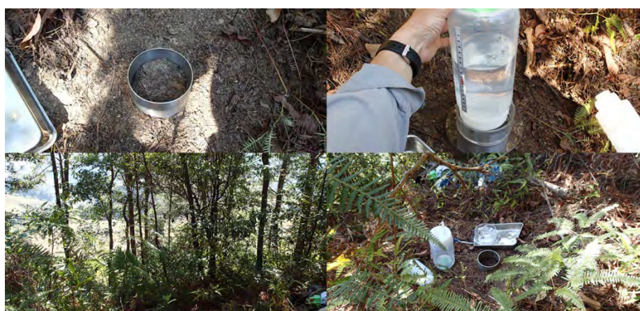
図 4-2-2-10 林地における現地浸透能試験の様子(2022 年 12 月)
