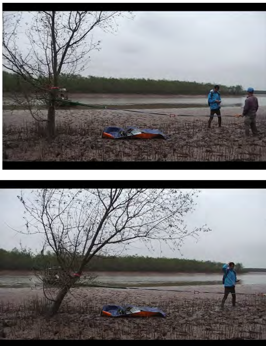
図 4-4-5-3 XTNP の Sonneratia caseolaris を対象とした引き倒し試験風景
