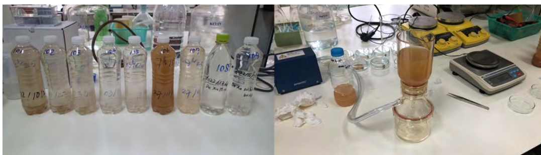
図 4-2-2-7 観測所で収集した採水試料(左)と VAFS 実験室での浮遊砂濃度測定状況(右)
