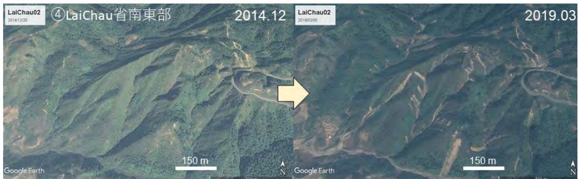
図 4-2-2-7 ライチャウ省南東部④の崩壊発生前後の衛星画像
