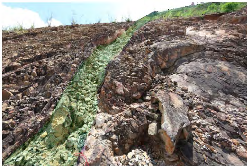
写真 9.断層ガウジを伴う破砕帯
