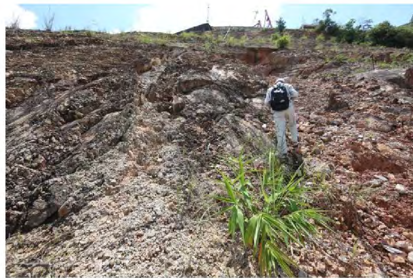
写真 10.断層下に面的に分布する破砕帯
