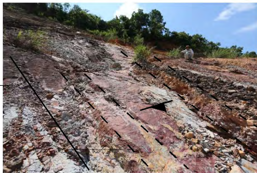
写真 8.断層下の流れ盤構造の地層
